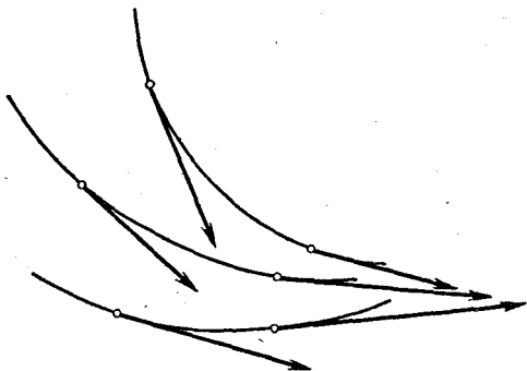
Рис. 14.1. Скорости частиц движущейся жидкости и линии тока.
